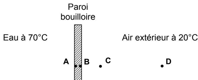
On cherche à diviser le flux thermique par cinq. Pour cela, on accole à la paroi de la bouilloire de surface  $0,12 \text{ m}^2$  une couche d'isolant mince de même surface. On considère alors que la bouilloire et l'isolant mince constituent un assemblage de parois planes.
