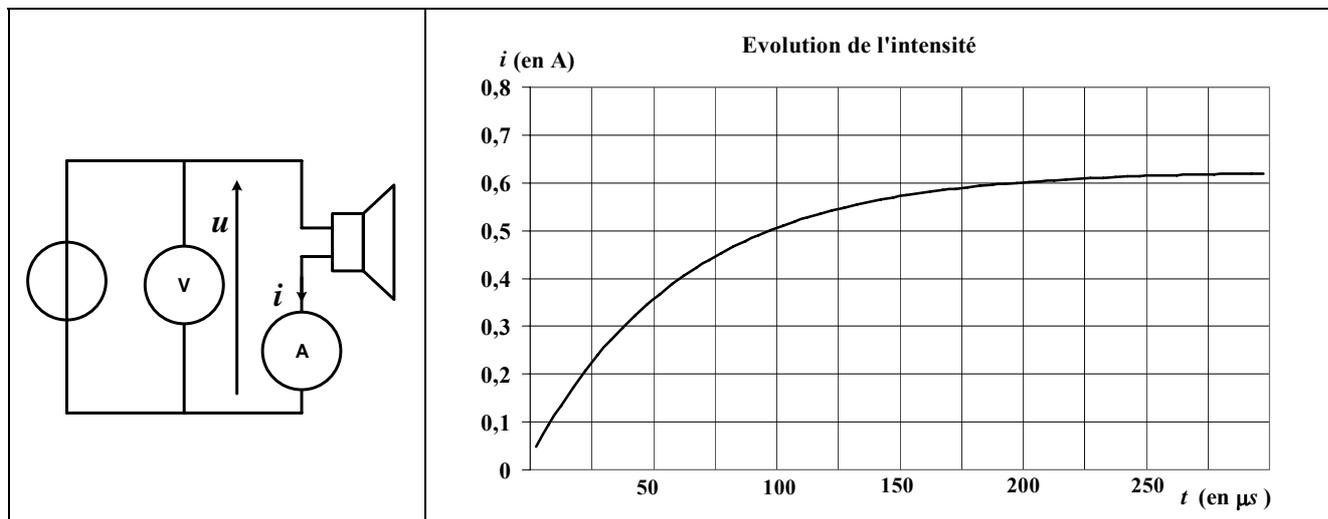
Le système d'acquisition en courant possède une résistance interne  $R_A = 2,0 \Omega$ .
