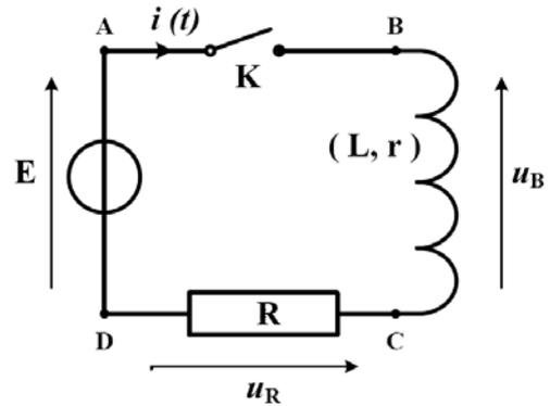
On branche aux bornes de la résistance  $R$  une carte d'acquisition informatisée permettant de visualiser les variations de la tension  $u_R(t)$  après la fermeture de l'interrupteur  $K$  à  $t = 0$ .
