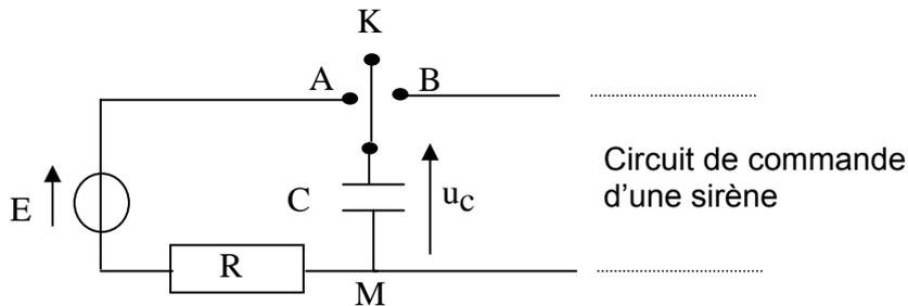
Lorsque le coffre est fermé, l'interrupteur K est en position A, le condensateur de capacité C se charge. Dès l'ouverture du coffre, l'interrupteur bascule en position B et le condensateur se décharge dans le circuit de commande de la sirène.
