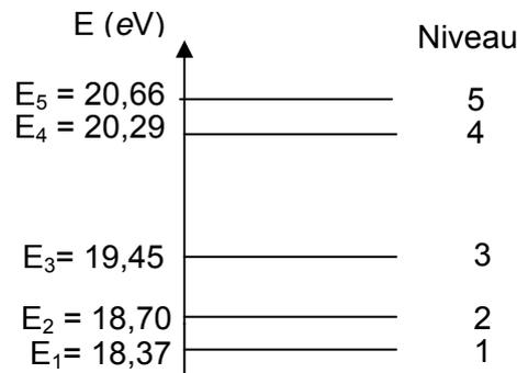
**Fig. 1 : Diagramme énergétique simplifié du néon**
