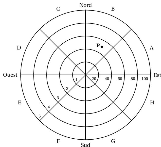
Le capteur de foudre étant représenté par le centre de l'écran, cinq cercles concentrique correspondant aux rayons respectifs 20, 40, 60, 80 et 100 kilomètres délimitent dans l'ordre cinq zones, numérotées de 1 à 5, définies par leur distance au capteur. De plus, huit segments partant du capteur délimitent huit portions, de même ouverture angulaire, nommées dans le sens trigonométrique de A à H.
